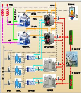
热电冷三联供+污水源热泵系统原理图
